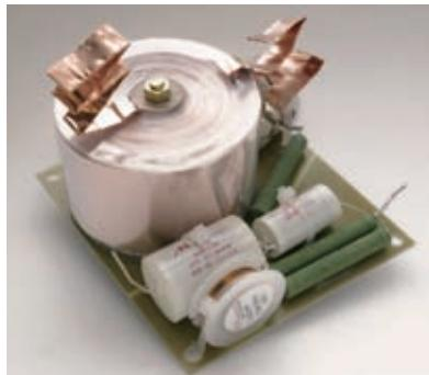
及運用無酸銅扁帶繞製的電感線圈，內部接線全屬直徑達 6mm，採用同軸式規劃的美國 Cardas SE9，從生產商網頁提供資料，顯示這款運用黃金比例鋪排，正負極共包含 234 股導體，並擁有恆定 Q 值的發燒產品，內外兩組線芯各自被一層不受溫差濕度影響的鐵弗龍包裹，外圍再加入厚厚的聚乙烯 PE 作保護。價錢方面，SE9 的每呎零售價超過一百港元，參看 Ella 的零售價，廠方可謂交足貨有餘了。整份分音器採用點對點人手鉗接，此外每對揚聲器在出廠前需交由總舵主親自測試和聆聽，確保所有產品能佰份佰符合他的嚴格要求。
