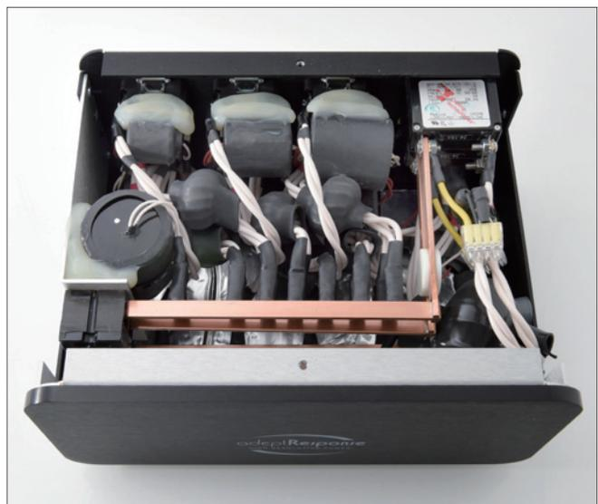
是一個衡量電路儲電能力的參數，因為電容器和能產生磁場的電感器都會儲電，一個在正弦波上升段儲電，一個在下降段儲電，正好相反。這種儲電是有害現象，例如一台設備的電流是 10A，但實際上只消耗 6A，多出來的 4A 只是用來建立磁場而已，我們可以利用電容器相反的特性作補償，比如說使總電流由 10A 降至 8A，整個電路便有更大空間容納瞬態電流上升，那為什麼不使其降至 6A 呢？不行的，因為一正一反如果力度一樣的話會產生諧振，那可是一種嚴重的故障。
